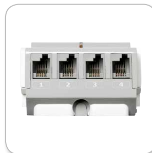
Miejsce podłączania czujników
