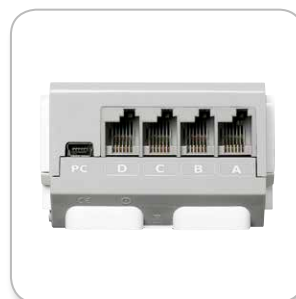
Miejsce podłączania silników
